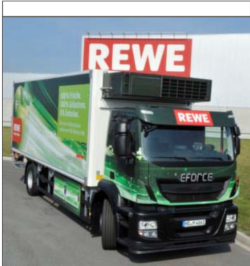
Der Antrieb des E-Lkw kommt von E-Force One, das Fahrgestell ist ein Iveco Stralis. (Bild: Rewe)
